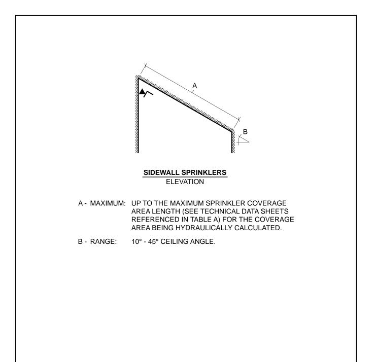
FIGURE 2 — PART 6 of 6 SPRINKLER SPACING UNDER SLOPED CEILINGS —SIDEWALL SPRINKLERS LOCATED AT PEAK —
